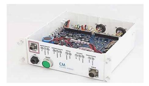
Fig. 8. BIOWYSE Control Module
