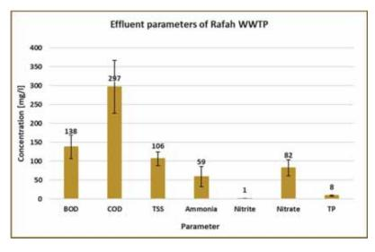
Fig. 4. Effluent Parameters of Rafah WWTP
